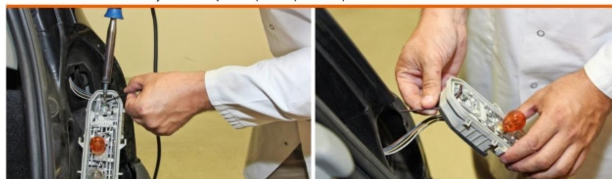
**3 Soudez un fil sur la plaque de masse.** Dénudez un fil de 10 cm de long et, à l'aide d'un fer à souder et d'étain, fixez-le sur la tôle de la plaque. Passez le fil à travers la platine, afin qu'il ressorte vers le connecteur.
