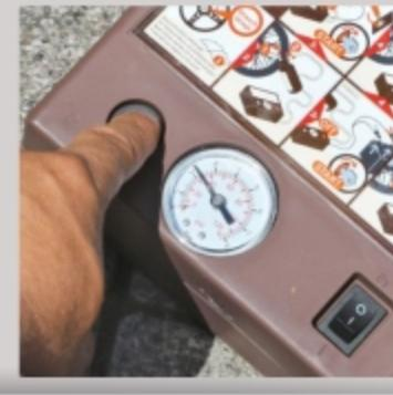
**4 Contrôlez.** Si la pression est supérieure à celle que vous aviez faite\*\*, c'est réparé ! Ajustez-la sur les deux pneus de l'essieu, surgonflés de 0,3 bar.
