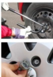
**1 Accédez aux écrous de roue.** Pour atteindre les écrous, tirez fermement sur l'enjoliveur (veillez à placer l'encoche en face de la valve au remontage !). Sur jante alu, retirez les caches des écrous à l'aide de la pince spécifique. Puis sortez la clé pour débloquer les écrous.
