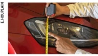
**1 Placez l'auto à 10 m du mur.** Vérifiez la pression des pneus puis, sur sol plat, mesurez la distance sol-axe de l'ampoule (ici, 67 cm).
