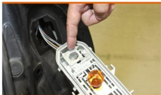
**2 Repérez la plaque de masse.** Cette petite tôle en acier relie les ampoules entre elles. Au niveau des fils, frottez sa surface sur 1 cm<sup>2</sup> à l'aide du dos gratteur d'une éponge ou de papier de verre fin (grade 180 ou 240).
