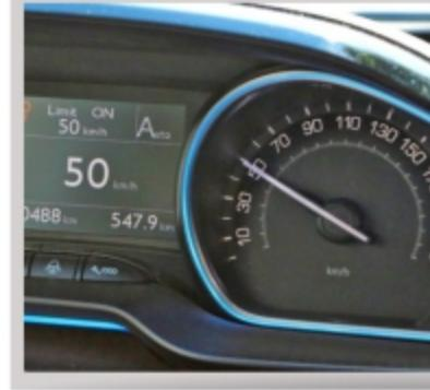
**3 Roulez.** Parcourez 3 à 5 km, à 50 km/h maxi, pour répartir le produit de colmatage de façon uniforme à l'intérieur de la bande de roulement.
