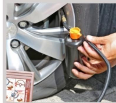
**1 Raccordez.** Vissez la cartouche de produit à la valve (placée à la moitié supérieure du pneu), puis ajustez le tuyau d'air du compresseur.
