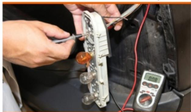
**4 Trouvez le fil de masse du faisceau.** A l'aide d'un ohmmètre branché entre la platine et la caisse (tôle ou vis), ou en suivant le cheminement du circuit, repérez le fil de masse (noir en général). Dénudez-le sur 1 cm.
