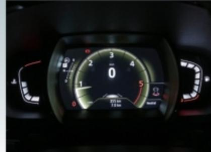
L'instrumentation entièrement digitale est lisible. Présentation et couleurs changent en fonction des modes de conduite sélectionnés (Eco, Sport, Confort...). Les lumières d'ambiance sont alors assorties.
