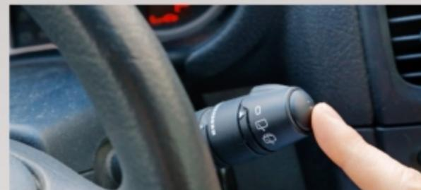
**1** Contact mis, faites défiler les informations de l'afficheur à l'aide du poussoir placé au bout de la commande d'essuie-glace, jusqu'à ce que l'échéance d'entretien s'affiche, puis...
