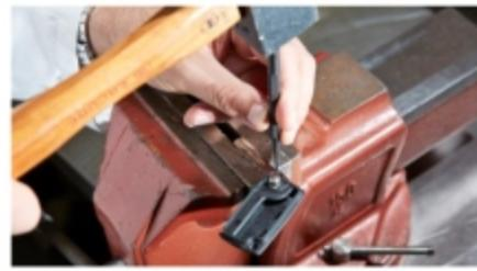
**1 Ouvrez la coque usagée,** afin de récupérer le circuit électrique et la pile (profitez-en éventuellement pour la remplacer!). Redisposez-les de la même manière à l'intérieur du nouveau boîtier.
