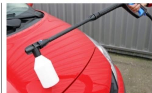
**1 Le diffuseur de mousse.** Il est à remplir de nettoyant multi-usage. Il se visse au bout de la lance. On peut ainsi rapidement "couvrir" l'auto.
