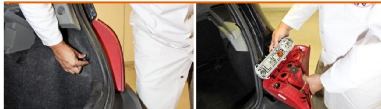
**1 Déposez le bloc de feux.** Dévissez l'écrou ou le papillon situé à l'intérieur du coffre (voir la marche à suivre dans votre livret utilisateur). Puis déclipsez la platine porte-ampoules en laissant le connecteur branché.
